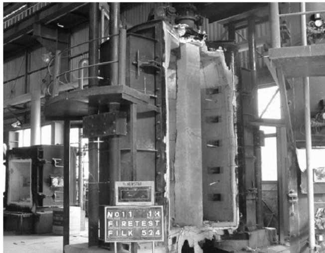
[그림 10] 일반강도 철근콘크리트 기둥 가열후 모습
