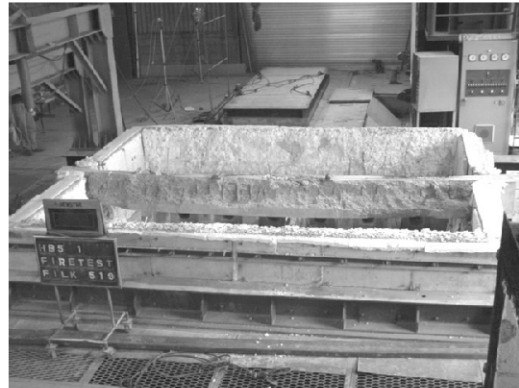
[그림 6] 고강도 철근콘크리트 가열 후 모습
