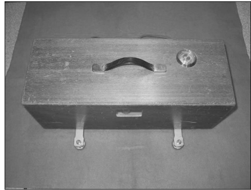
〈 그림 1 〉 경량충격음 음원발생기 (Tapping Machine)
