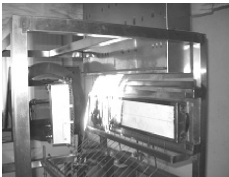
[그림 4] FTP 코드에 의한 표면연소성 시험
