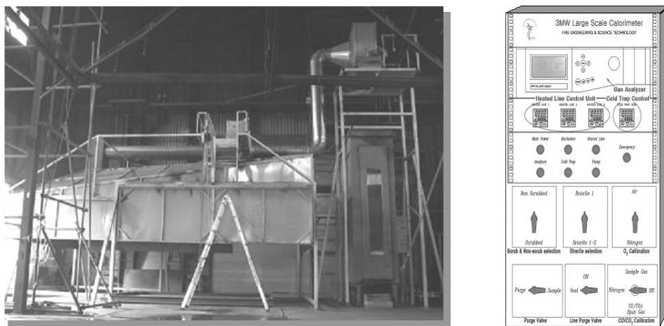
[그림 1] Large scale calorimeter 시험장치(左) 및 열량측정 가스분석기(右)
