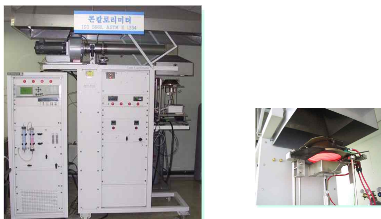
[그림1] 콘칼로리미터 시험장치 (ISO 5660-1)
