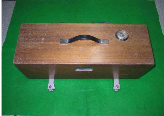
[그림 1] 경량충격음 음원발생기(Tapping Machine)
