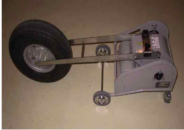
[그림 2] 중량충격음 음원발생기(Bang Machine)
