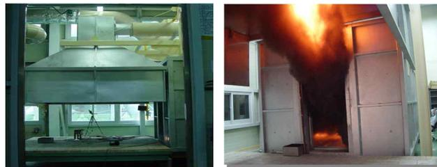
그림5 ISO 9705 (Room corner Test) 화재시험모습(2007)
