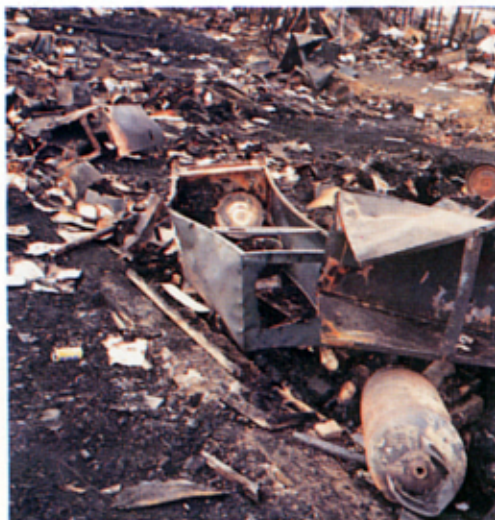
〈화재피해 모습〉 사진 우하부분에 프로판가스용기가 보인다. 용기 상부에 구멍이 뚫어진 모습이 선명하게 보인다.
