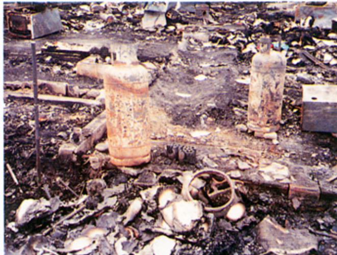
〈연소확대의 한 요인이 된 프로판가스 용기〉 가스가 새어 나오면서 폭발적으로 연소되었다.
