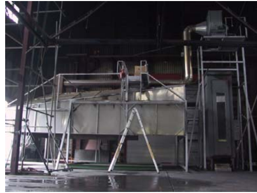
【ISO 9705 실 코너 시험장비】 【ISO13784-1 건축용 샌드위치 패널재의 화재시험장치】
