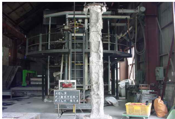
[그림 1] 폭열현상이 발생한 고강도콘크리트 기둥
