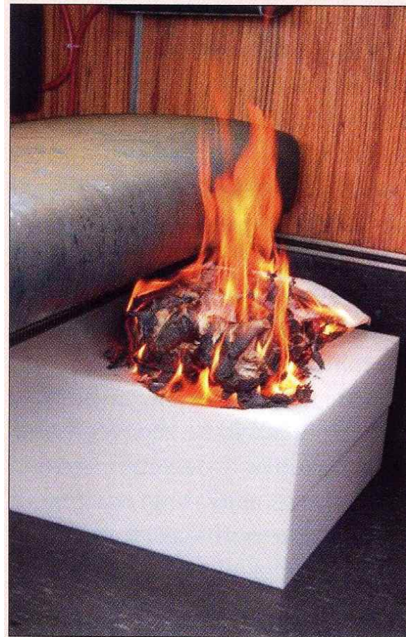
<그림 3. 쿠션의 화재 실험(UIC 쿠션 점화 후 IMO 쿠션 연소)>
