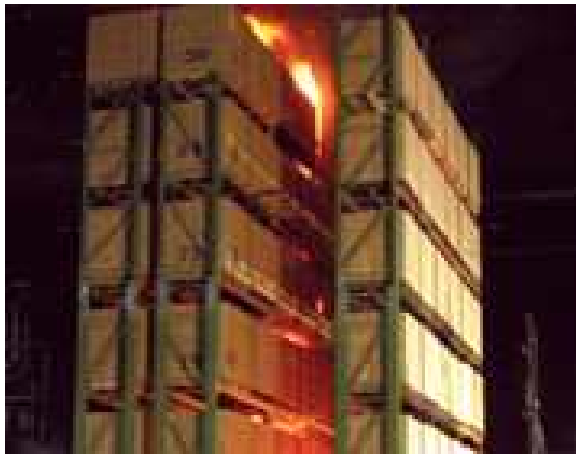
<그림-1> 35~40 ft 높이의 천장 내 플라스틱물품 창고 화재에서의 표준형 스프링클러 성능
