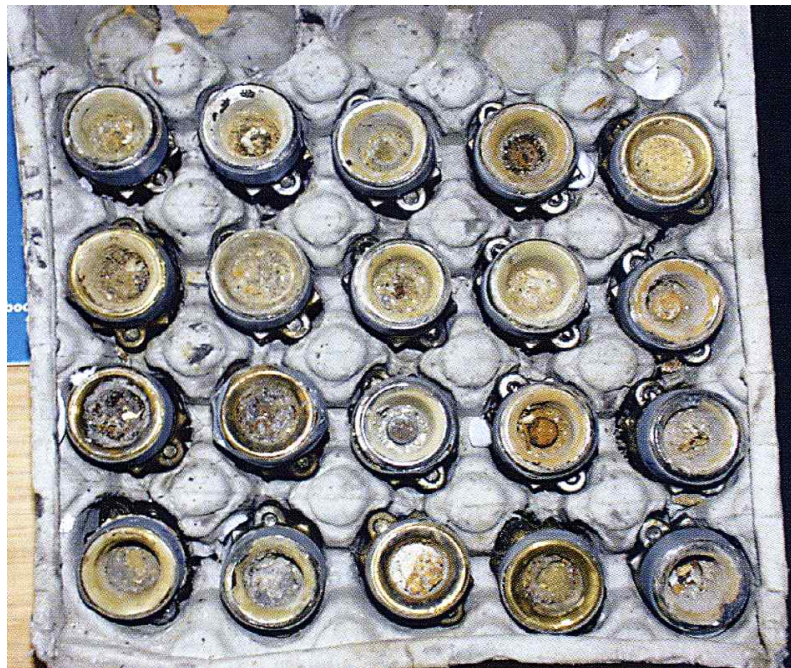
그림 4: 하나의 시스템에서 스프링클러 20개의 대표적인 묶음(batch) 플러그의 무거운 외피가 분명하게 보임.
