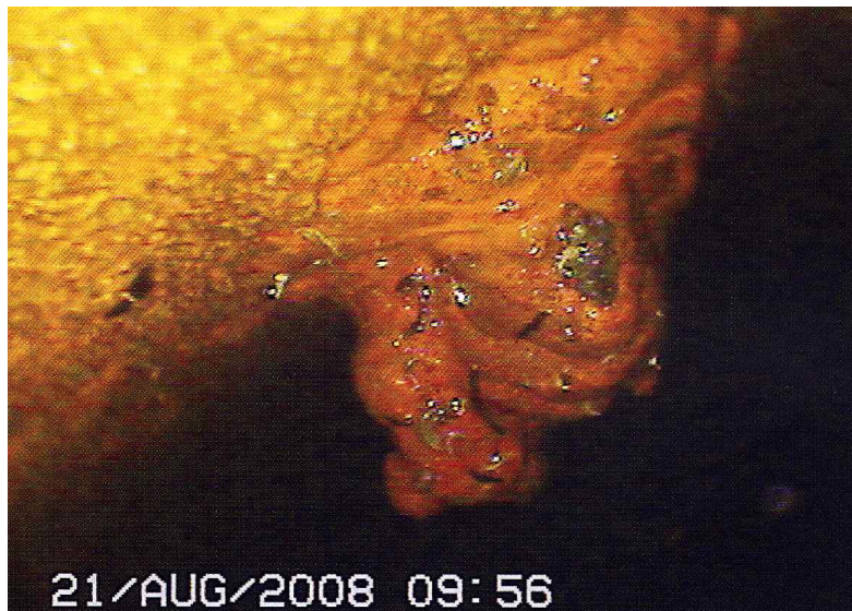
그림 1: 비디오 내시경을 통해 본 모습. 매우 큰 부식 폐쇄가 있는 파이프 벽이며 폐쇄의 크기는 C.25mm에서30mm이고 구멍의 크기보다 더 클 가능성이 높다.
