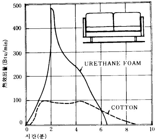
註：露出溫度가  $970^{\circ}\text{F}$  以上일 境遇에는 urethane과 cotton의 热 放出量에는 거의 差異가 없다. 따라서 어떤 物質의 热 放出量은 試驗된 條件에 그 基礎를 두어야 한다. 예를 들어 음향 조정 천정재는 試驗時 높은 温度를 露出시켜 주어야 한다.
