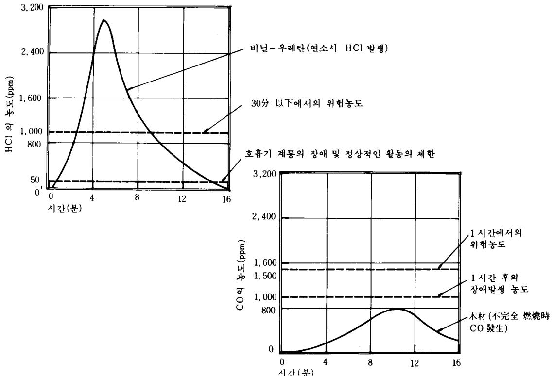
註: PVC 등과 같은 보통의 플라스틱 燃燒時에도 HCl 이 發生한다. 燃燒物은 위험 농도에 이르는 많은 有독 가스를 發生시키는데 예를 들어 가죽과 Wool이 燃燒時에는 H<sub>2</sub>S, 고무와 Wool이 燃燒時에는 HCN이 發生한다.
