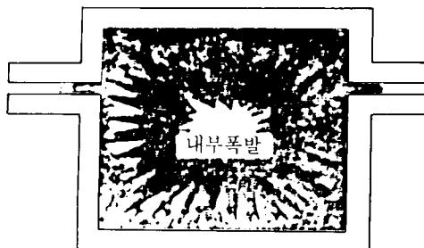
점화원이 된 우려가 있는 부분을 전폐구조에 넣음으로서, 외부 폭발성 가스가 침입하여 폭발하여도 그 압력에 용기가 견디고, 고열 및 가스가 용기의 접합부 틈으로부터 새는 일이 있어도 외부의 폭발성 가스를 점화시키지 않는 구조
