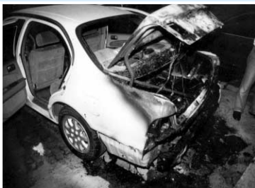
[사진 13] 트렁크 중심으로 연소된 차량
