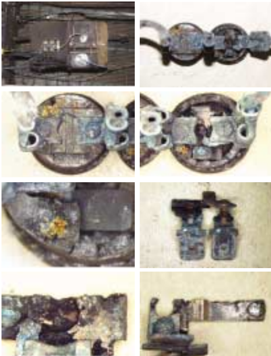
■ 사진 8. 정수기의 과열보호용 써머스위치 커넥터 결선부분 불완전 접촉 발열이 원인이 되어 발화된 예
