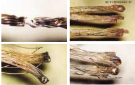
■ 사진 5. 콘센트와 플러그의 접속부분 불완전 접촉 발열에 의해 발화된 예
