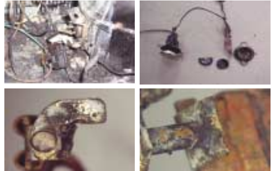
■ 사진 9. 정수기의 과열보호용 써머스위치 부분 접점에서의 불완전 접촉 발열흔적
