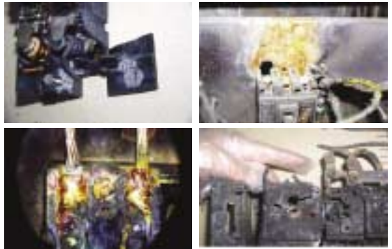
■ 사진 2. 밥솥 내부 결선부분 불완전 접촉 발열에 의해 발화된 예
