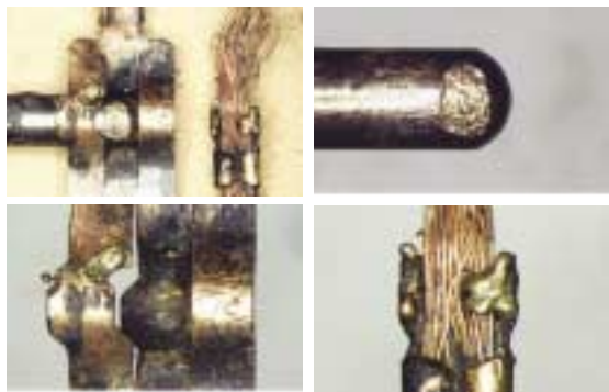
■ 사진 5. 콘센트와 플러그의 접속부분 불완전 접촉 발열에 의해 발화된 예
