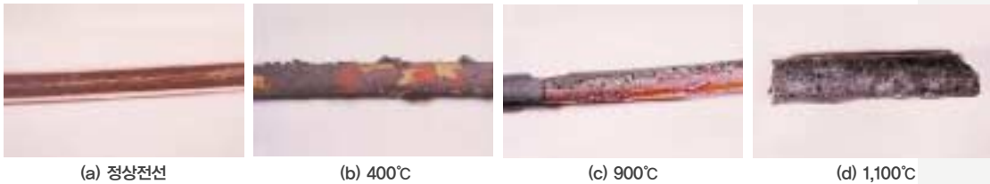
■ 그림 5. 열적 스트레스를 받은 전선의 실제 사진(Mag.×10)
