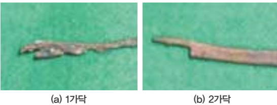
■ 그림 9. 외부화염에 의해 소손된 전선의 표면구조 변화
