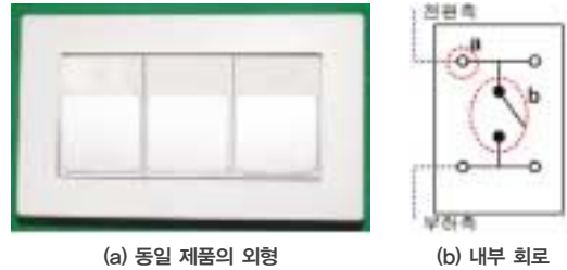
■ 그림 1. 스위치의 외형 및 내부 회로
