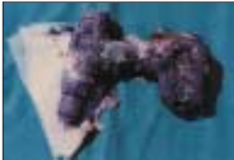
■ 그림 20. 착화 후 19분 경과한 사진(전면)
