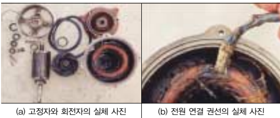
● 그림 9 • 배수용 펌프를 분해한 실체 사진
