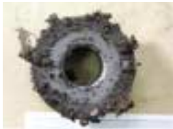
〈그림 3〉 현장에서 자석을 이용하여 용접불똥을 수집한 결과
