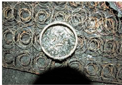
〈사진 27〉 연소 중심부에 위치한 재떨이의 잔해
