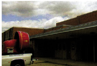
〈그림 4〉 트레일러에 설치된 배기용 고정 팬
