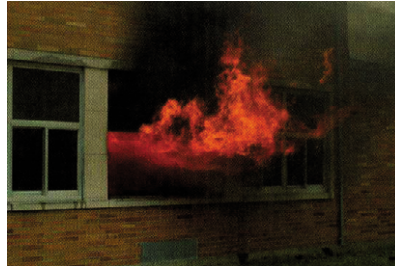
〈그림 2〉 화재실 창문을 통한 배출 실험(자연 배기)
