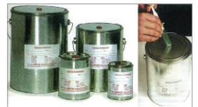
〈사진 2〉 인화물질 채취용으로 이용 되는 페인트 빈통(좌)과 분석 실험을 위해 가스를 채집(우)하는 형태 (Forensic Science by Richard Saferstein, Prentice Hall, 2008)
