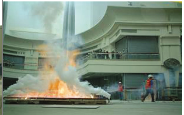
<사진 5> 실제크기 화재시험 장면
