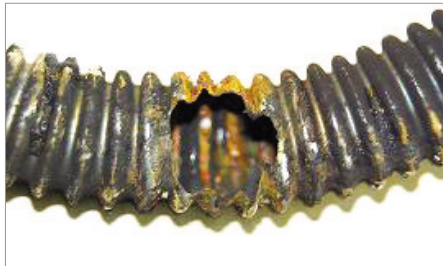
[사진 6] 지락전류의 통로를 구성하는 보일러 가스배관의 용융형태(가스 누출)
