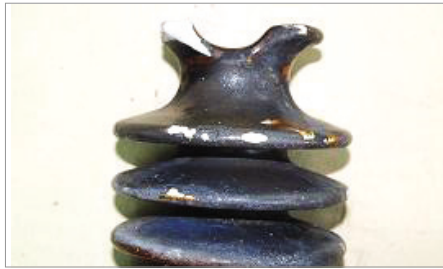
[사진 2] 낙뢰에 의해 파손된 고압선로 애자 형태
