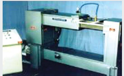
〈그림 7〉 RTI 측정용 열기류감도시험장치
