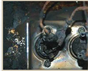
〈그림9〉 내부배선의 금속부에 의한 절연파괴
