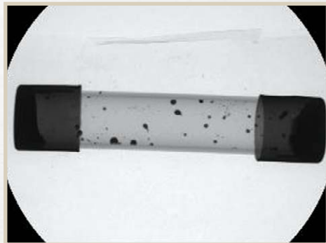
〈그림11〉 전원퓨즈의 내부 비산 흔적(과전류)
