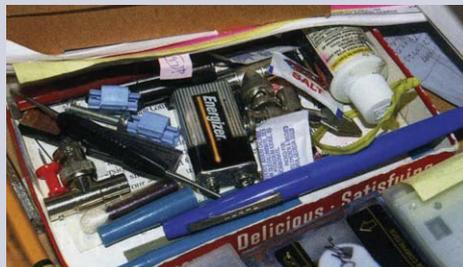
사진2. PP3 배터리의 일반적인 저장 장소는 책상 서랍이다. 사진은 배터리 단자 가까이 있는 금속 펜 클립과 기타 금속 물질을 보여준다.
