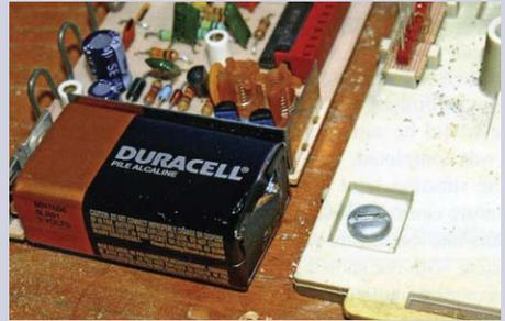
사진8. 센서 회로의 파열된 배터리
