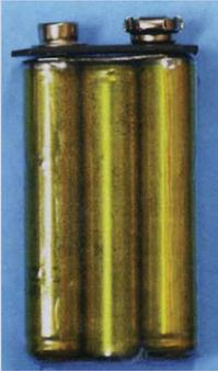
사진3. 직렬로 연결된 6개의 AAAA 1.5V 셀을 분해한 PP3 배터리
