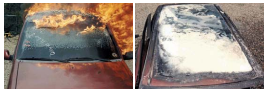
(c) 연소 확대 모습(착화 후 7분 경과) (d) 화재 진입 후 차량 지붕의 연소 흔적
