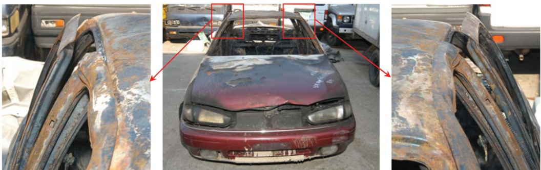
[그림 6] 인화성 물질을 사용한 차량방화의 출입문 변형 형상
