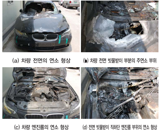
[그림 8] 차량 빗물받이 부분에 방화를 시도한 사례
