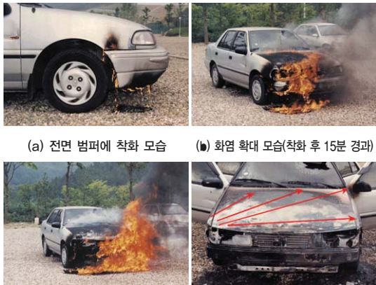
(c) 연소 확대 모습(화성기, 착화 후 16분 경과) (d) 화재 진압 후, 차량 후드의 연소 흔적
