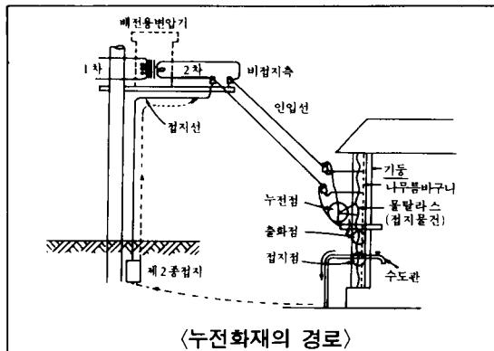
위의 그림은 인입선 비접지측이 함석판에 접촉 누전, 몰탈라스와 수도관을 타고 지면으로 통하는 누전경로를 나타낸다. 이때 몰탈라스 부분이 발열되면서 목재부분에 착화, 화재가 발생한 누전경로를 표시한 한 예이다.
