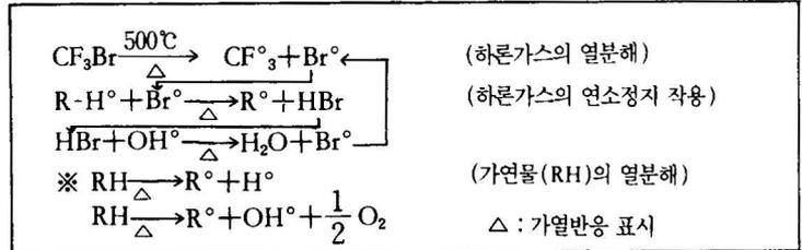
21%에서 약 15% 이하로 감소시켜서 소화한다. 또 냉각효과도 약간 겸하고 있다. 이 두 가스는 무색, 무취로서 가스 자체에 독성이 없고 전기절연성이 높아 고전압기기의 운전중에도 사용시 위험성이 적고 화학적으로 안정된 소화약제이므로 오랫동안 소화력을 유지할 수 있으며 상온에서 액화되기 때문에 액화가스로서 저장 또는 운반이 용이하다.
