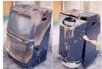
대부분의 누설에 의한 폭발이나 화재는 커플링 부분의 불완전 결합, 내부 벨브시트 레버 받침쇠의 파손으로 일어나며, 받침쇠의 파손 시 파손된 부품이 가스용기 속으로 들어가게 되어 있다. 커플링 부분이 소실되면 금속부분만 남게 되며, 내장된 스프링에 의하여 열림 상태였던 것도 잠김 상태와 같은 형상을 나타내게 된다. 대부분의 경우 누설부위에 착화되어 연소흔적이 남아 있는데 화염에 의해 몸체나 용기 몸체에 국부적으로 수열된 형태가 남는다.
