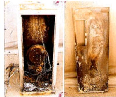
연료의 누설인 경우 급격히 연소가 확대되어 그을음은 다소 적은 편이나 누설부위에서 화염 연소흔이 나타나며, 점화불량으로 연소실 내에 연료가 누적되었다가 일시에 연소되어 과열되면 연소실 내부에 연료의 누적흔적과 회화된 형태가 남게된다. 자체 전기 장치에서의 발화는 전선보다는 바닥부분의 가연물에 불씨가 뛰어 착화하게 되므로 발화부분에서 역삼각형의 연소흔적을 남기게 된다.
